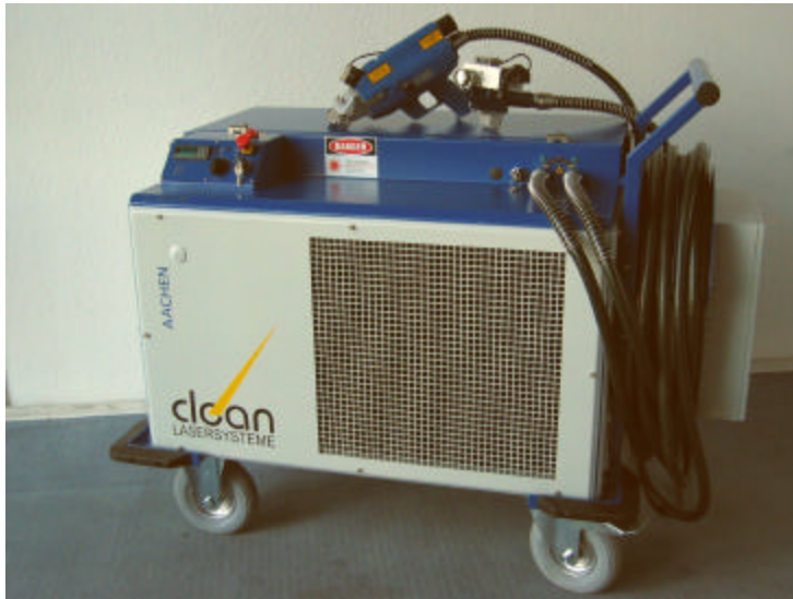
Bild 4: Mobile, leistungsstarke Laseranlagen bis zu 500 W
