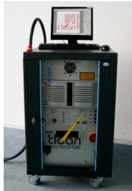
Bild 4: Mobile, leistungsstarke Laseranlagen bis zu 500 W
