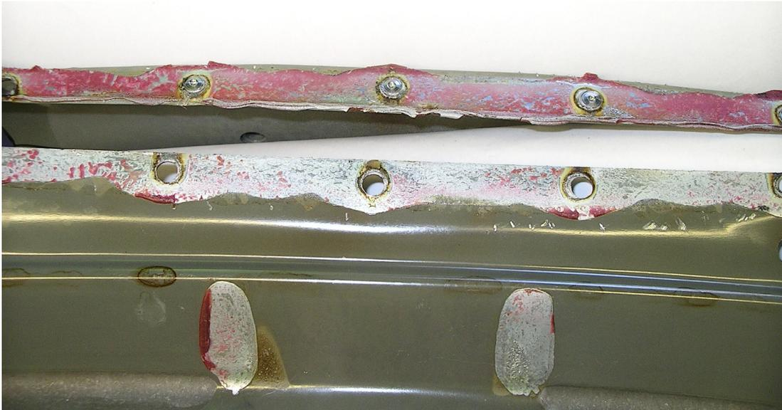
*Bild 4: Adhäsives Trennen einer Strukturklebung ohne Klebstoffpyrolyse*
